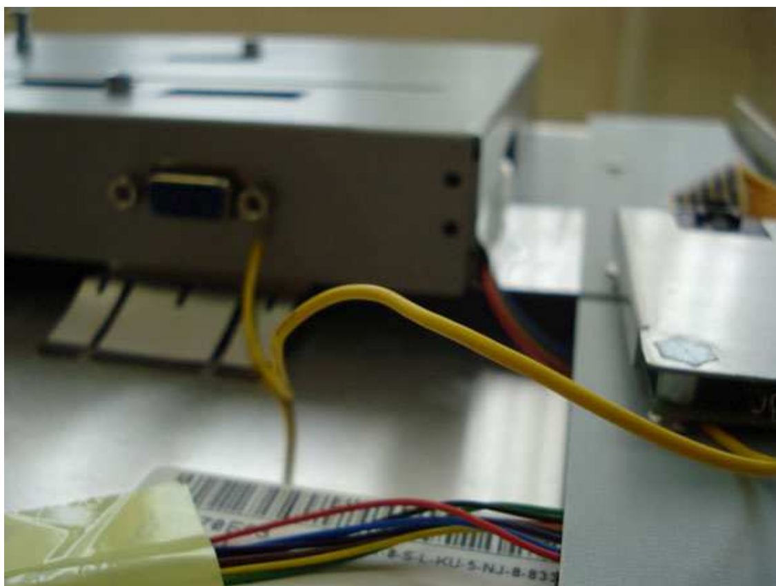
Рисунок 17: Заземляем. Лучше припаять к шпильке. Будет лучше работать.
