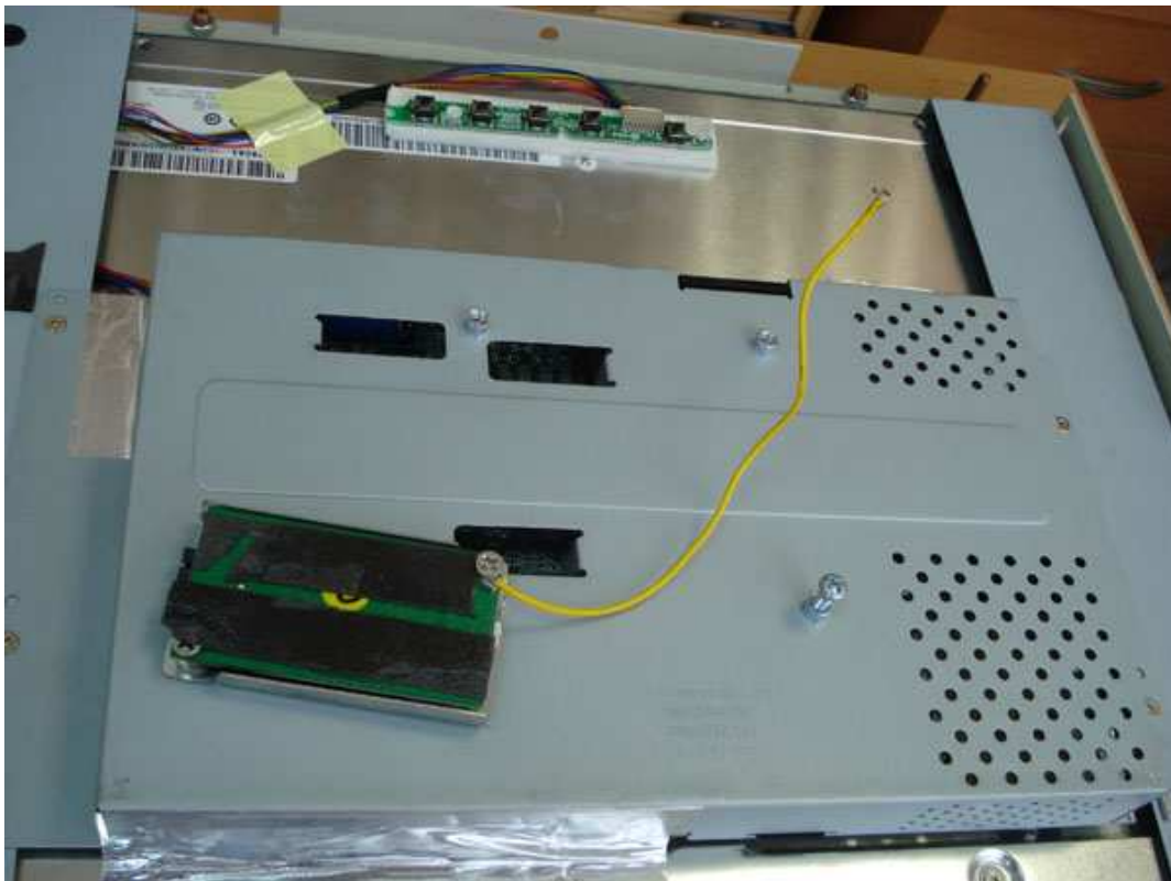
Рисунок 15: контроллер с скотчем и проводом заземления
