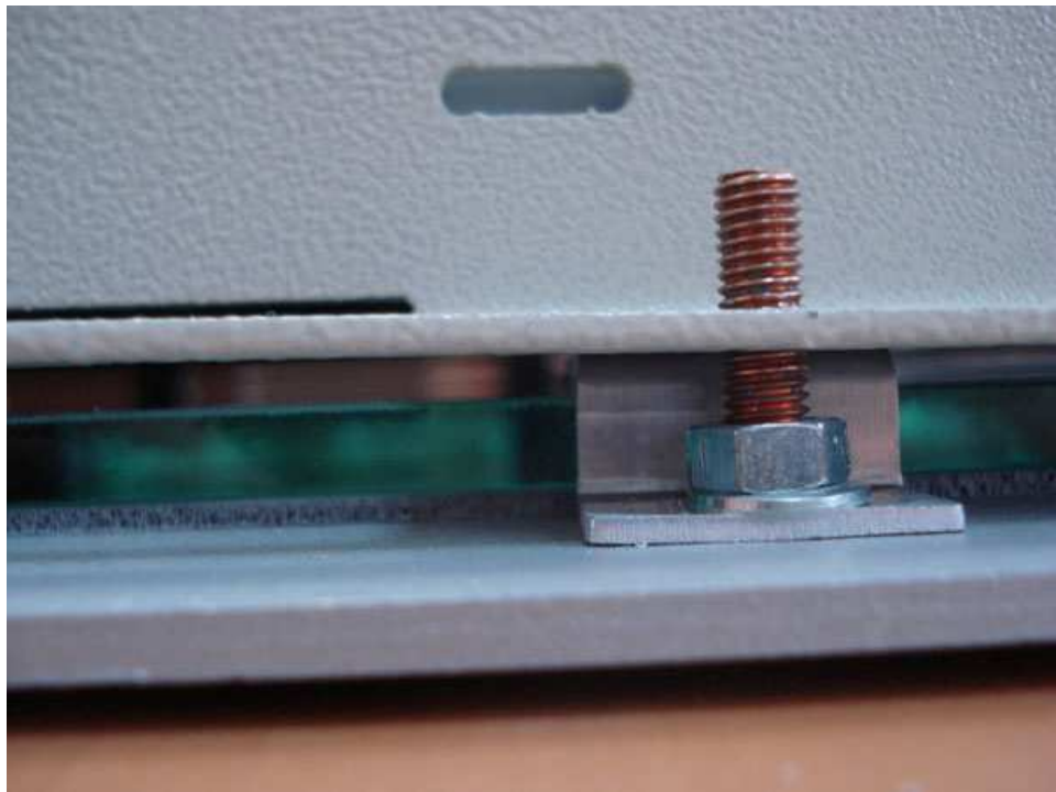
Рисунок 12: Не должно быть контакта между стеклом и сборкой
