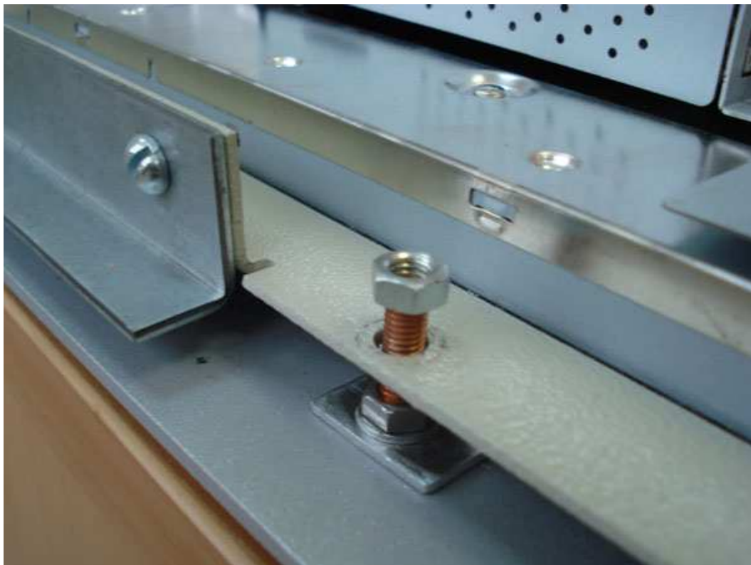
Рисунок 13: собираем сборку, лучше не забыть положить шайбу .
