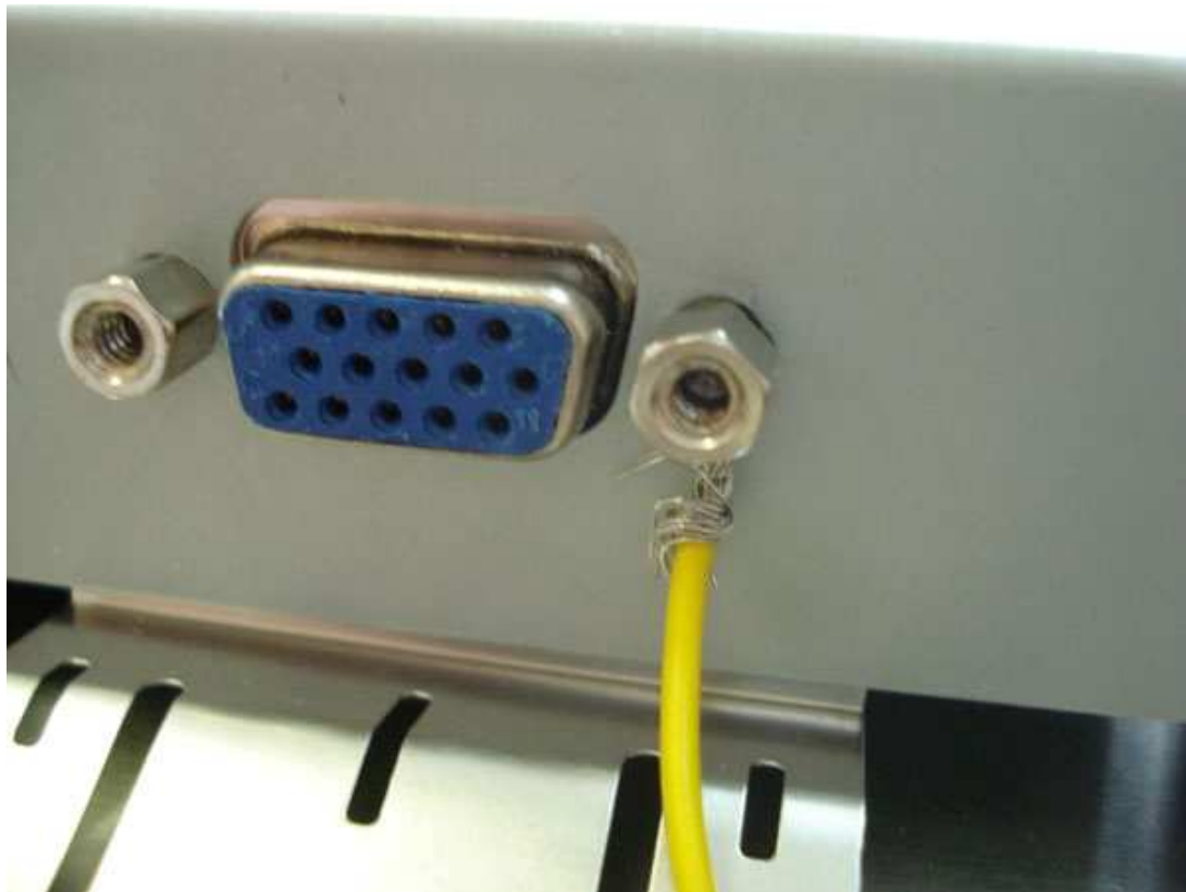
Рисунок 18: Это не самый лучший вариант. Самый лучший – припаять землю на шпильку
